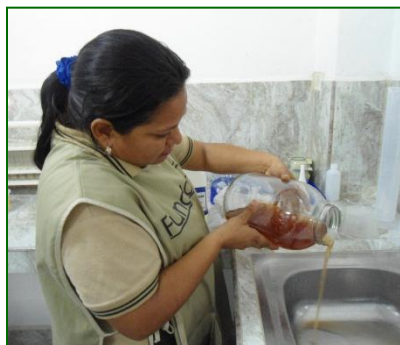
Ing. Lisdayni Arias, realizando proceso de decantación para extraer nemátodos.
